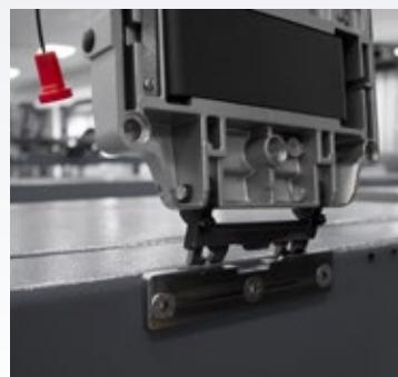
Pedana perforata per il montaggio delle staffe a supporto delle teste di misura dell'assetto ruote 3D Space. (Solo per modelli 02, 03, 05).
